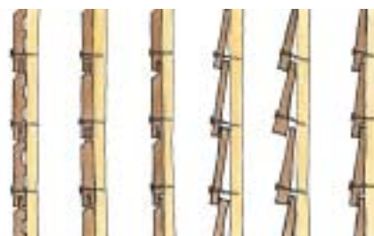
Différents types de pose du bardage horizontal
